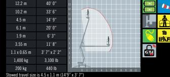
REACH HEIGHT PLATFORM HEIGHT UP AND OVER HORIZONTAL REACH HEIGHT STOWED DEPLOYED WIDTH PLATFORM SIZE WEIGHT LIFTING CAPACITY
